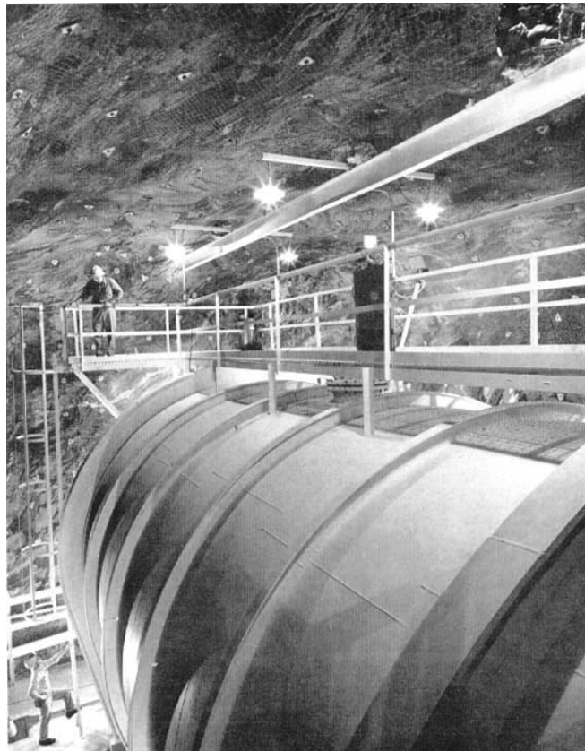
Gb.1. Tangki tempat mendeteksi Neutrino berdiameter dalam 6 meter dan panjang sekitar 14 meter, diletakkan 4850 kaki (sekitar 1,5 kilometer dibawah tanah). Tangki ini diletakkan dibawah tanah supaya klor yang ada dalam tangki tidak berinteraksi dengan partikel-partikel lain dari matahari, selain neutrino.
